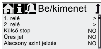
36. ábra 'Beállítás > Bemenetek/kimenetek' menü
