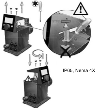
7. ábra A vezérlőpanel elrendezése
